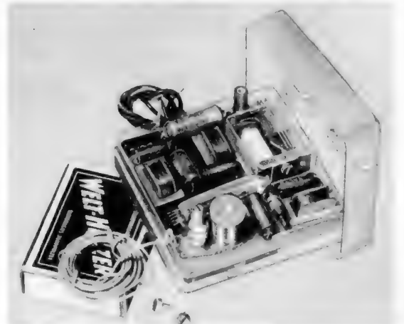
Bild 2. Der fertig aufgebaute Empfänger im durchsichtigen Schutzgehäuse (mit Streichholzschachtel als Größenvergleich)
