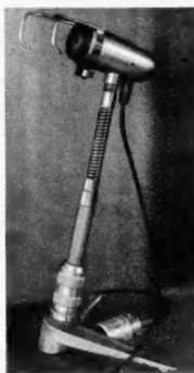
Das Mikrofon mit Abstandsgabel bewirkt den richtigen Mikrofonabstand, um die Sprache klar aus den Umweltschallgeräuschen herauszuheben
